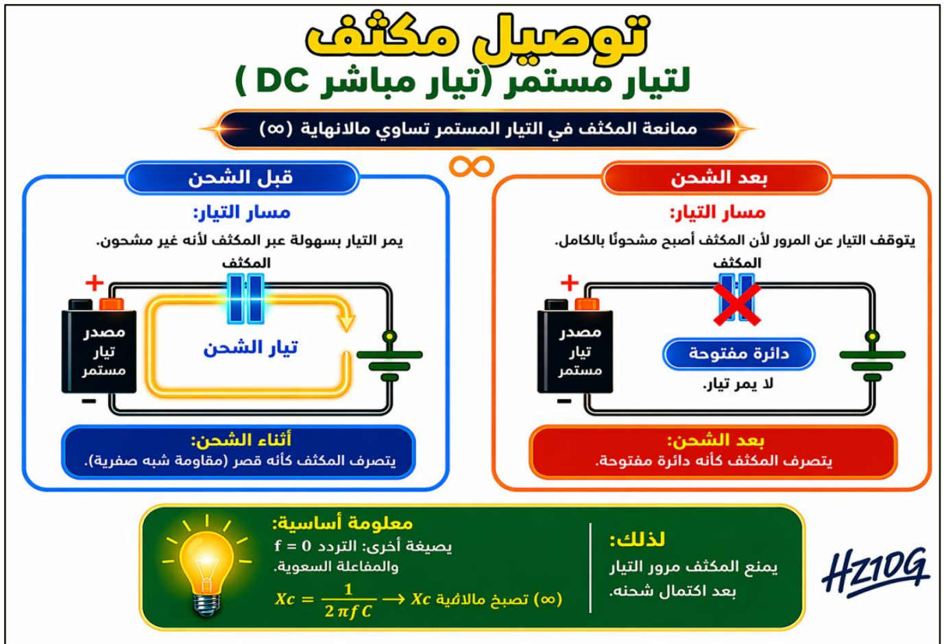
شكل (٦-١٦): استجابة المكثف للتيار المستمر قبل وبعد الشحن.
