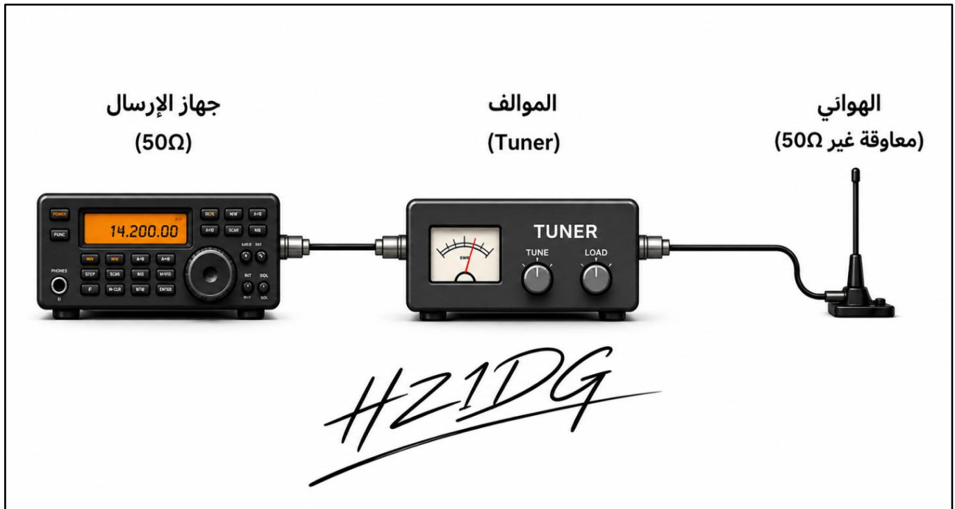
شكل (٢-٨): استخدام الموالف لمطابقة المعاوقة بين جهاز الإرسال (٥٠ أوم) وهوائي غير متوافق.
